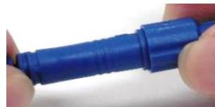
4. カメラ用ケーブルと、カメラから出ているコネクタの矢印を合わせて水平に差し込む。
