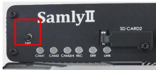
**本体設置位置の校正（手動校正）は1回のみで十分ですが、本体の設置位置を変更する場合は、必ず再度、本体設置位置の校正（手動校正）を行ってください。**
