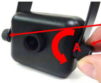
取り付け時、カメラの角度調整をする場合、Aのネジを反時計回り（左回り）で緩めて、調整してください。
