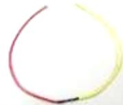
※無電圧車速パルス車でない車両にプルアップハーネスを取り付けると、メーターが破損する
