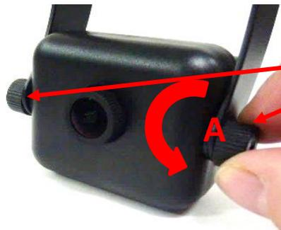
取り付け時、カメラの角度調整をする場合、
