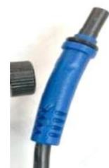
※しっかりと接続されていない、また、コネクタ部分に圧等（右写真）がかかる取付は、車の振動などで接触不良が起こり、カメラエラーや取得映像にチラつきなどが出る場合がありますのでご注意ください。カメラエラーやチラつきが出た場合は、再度コネクタ部分を外し、再接続を行ってください。
