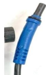
※しっかりと接続されていない、また、コネクタ部分に圧等（右写真）がかかる取付は、車の振動などで接触不良が起こり、カメラエラーや取得映像にチラつきなどが出る場合がありますのでご注意ください。カメラエラーやチラつきが出た場合は、再度コネクタ部分を外し、再接続を行ってください。
