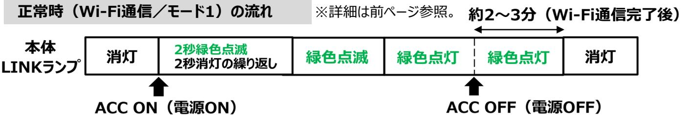
※ACC OFF後、Wi-Fi通信NGの場合、ACC OFF後約2～3分で強制的にシャットダウンします。
