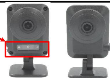
カメラの取り付け位置によって、撮影方向にカメラレンズがきちんと向かない場合は、Aのネジでステーの角度調整が可能です。
