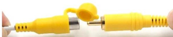
2. ビデオケーブル（RCA）の反対側と外部モニターなどのケーブルコネクタを水平に差し込む。
