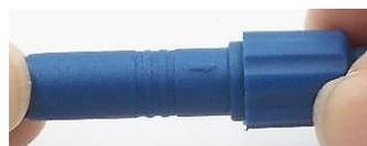
4. 防水カメラ用ケーブルと、カメラから出ているコネクタの矢印を合わせて水平に差し込む。
