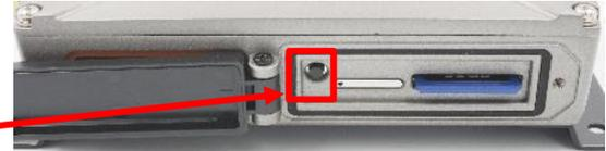
※SETボタンを1回押すごとに、外部モニターの画面が切り替わります。例えば、カメラ2台接続時、TV-OUT設定をカメラ2に設定した場合、SETボタンを1回押すごとに、カメラ1+2→カメラ1→カメラ2…と切り替わります。
