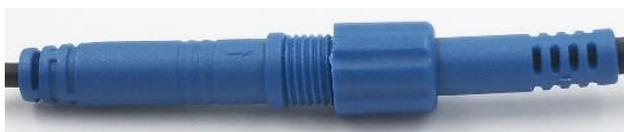
6. コネクタ間に隙間がないことを確認し、コネクタカバーを時計回り（右回り）に回し、しっかりと締める。
